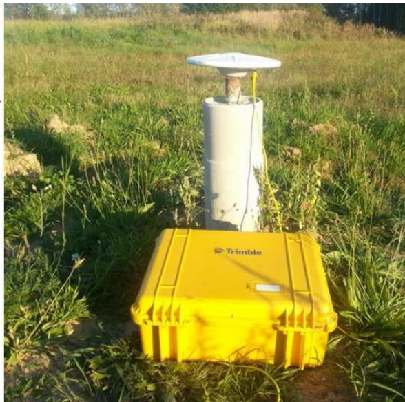
Сурет-1.4, а-мәжбүрлі орталықтандырылған GPS пунктiнiң дизайны; В-GPS сигнал қабылдағышы
